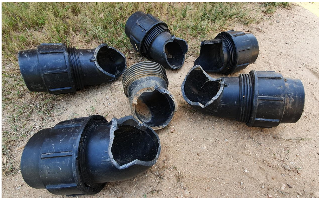
Figure 6. Rupture des raccords de tuyaux à Bredjing. Les conduites traversant les oueds nécessitent des réparations constantes.
