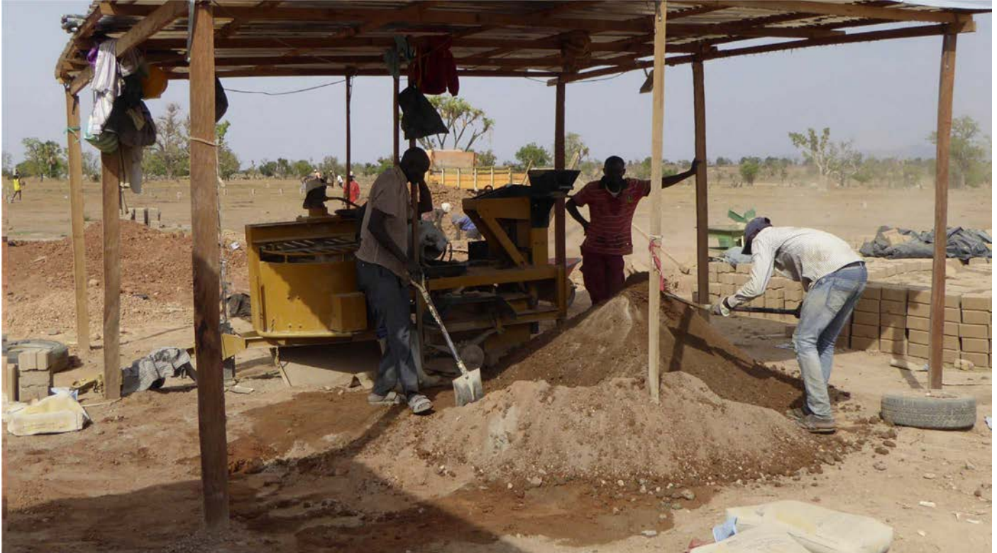
Production de blocs à l'aide d'une machine hydraulique mobile
