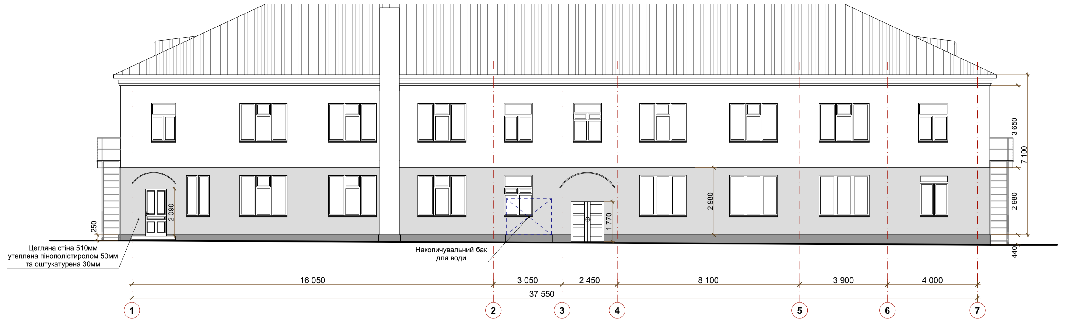
Обміри фасаду в осях 1-7
